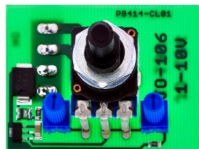
Nastavení minimální a maximální úrovně výstupního signálu
